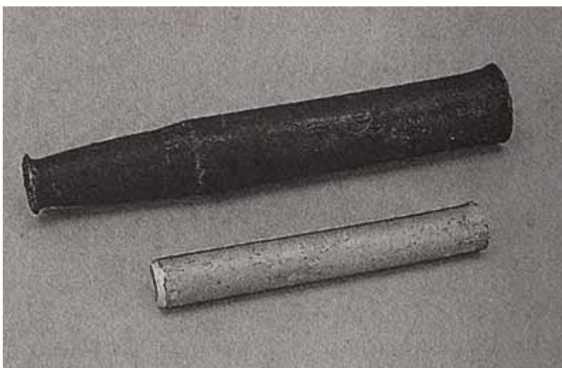
12. Набор выколоток и бородков из стали для выбивания штифтов, шплинтов и т. п.
