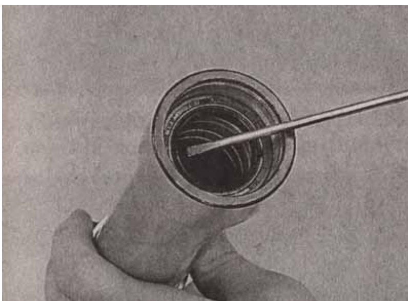
15. Извлекаем сальник вилки, поддев его шлицевой отверткой.
