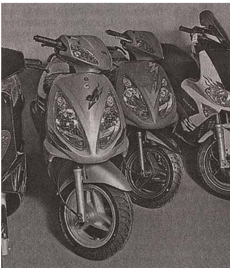
«Перевернутые» вилки современных скутеров
