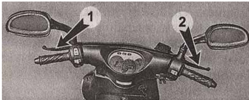
1 - рычаг заднего тормоза; 2 - рычаг переднего тормоза
