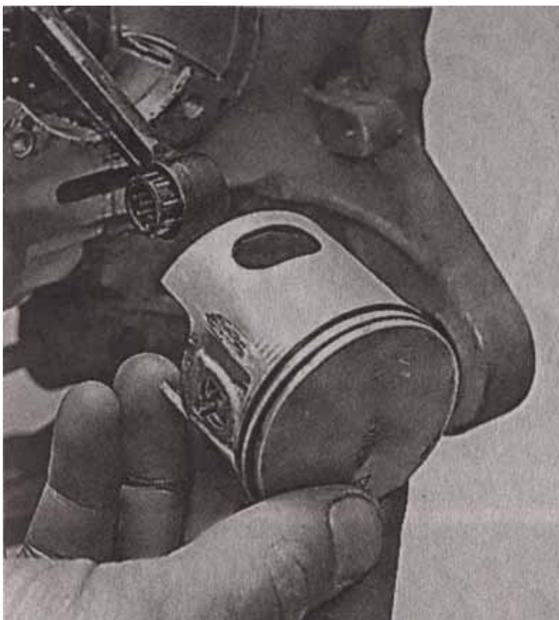
23. Извлекаем из верхней головки шатуна игольчатый подшипник.
