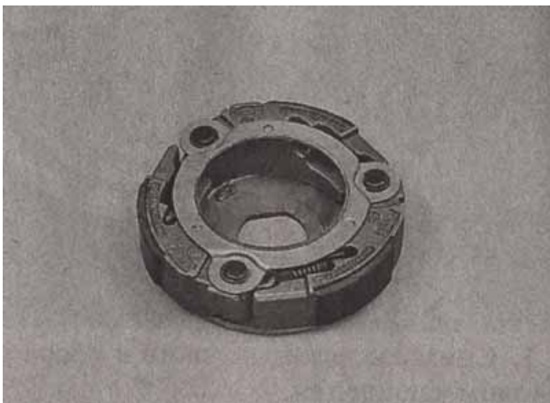
11. Узкими пассатижами снимаем стопорные кольца с направляющих колодок.
