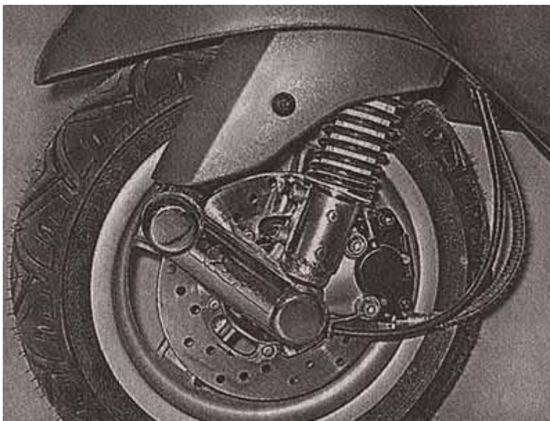
Современная короткорычажная подвеска ретро-скутера
